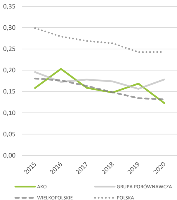
Rycina 5.7.8. Awarie sieci wodociągowej w przeliczeniu na 1km sieci rozdzielczej.
